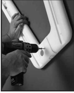
**Étape 4-2 :** Raccordez le dessus des montants à l'aide de deux vis autoforadruses #10 x 1 1/4 po (une sur la marque désignée sur le montant intérieur et une sur le montant extérieur).
