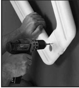
**Étape 4-7 :** Raccordez le dessus des montants à l'aide de deux vis auto taraudeuses #10 x 1 1/4 po (une sur la marque désignée sur le montant intérieur et une sur le montant extérieur).
