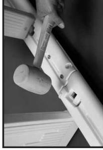
**Étape 4-4 :** Tapez sur le montant jusqu'à ce que la plate-forme soit enclenchée.
