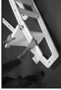
**Étape 4-3 :** Glissez un embout à languette de la plate-forme sous les montants le plus près du sol. Tout en faisant légèrement fléchir le montant du dessus vers le bas, faites glisser la plate-forme vers le haut de l'échelle jusqu'à ce que les languettes de la plate-forme s'insèrent dans les trous de blocage dans le montant.
