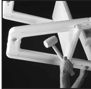
**Étape 4-9 :** Levez l'échelle debout et tapez la plate-forme vers le bas jusqu'à ce qu'elle soit fermement enclenchée.
