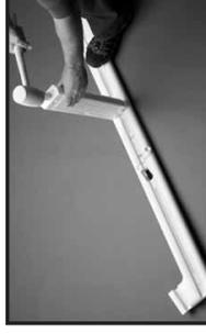
**Étape 2-1 :** Posez le montant assemblé sur une surface plate avec l'entaille de l'extrémité courbée vers le haut. Insérez la marche dans la deuxième ouverture à partir du haut et tapez-la pour l'enclencher. **REMARQUE :** L'entaille à la surface supérieure de la marche doit faire face à l'extrémité courbée du montant.
