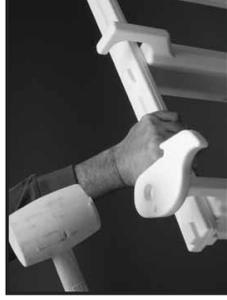
**Étape 3-5 :** Alignez le trou dans la came de verrouillage avec la languette ronde sur la marche de glissière à verrou et tapez dessus pour l'enclencher. Plusieurs coups de maillet en caoutchouc pourraient être nécessaires. Répétez la procédure sur l'autre côté.
