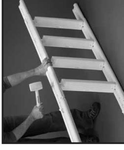
**Étape 2-3 :** Placez l'autre montant assemblé par dessus les marches de façon à ce que les ouvertures du montant s'alignent avec les extrémités des marches; tapez sur le montant pour l'enclencher.
