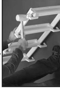
**Étape 3-4 :** Répétez l'étape 3-2 pour aligner les trous rectangulaires dans le raccord de marche restant avec les languettes sur les marches de glissière. Tournez l'échelle de glissière sur le côté et tapez le raccord de marche jusqu'à ce qu'il soit fermement enclenché.
